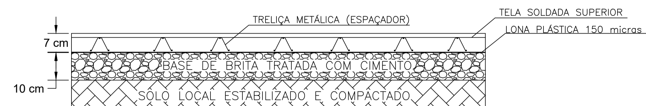
DETALHE – PISO DA QUADRA ESCALA 1/25
